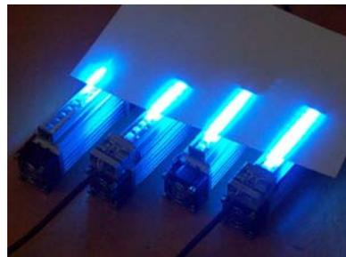
Les lampes LED-UV permettent de maintenir une haute intensité plus longtemps que les lampes à arc mercure.
