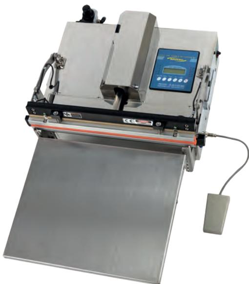
Conçue pour sceller les films thermosoudables, cette machine n'utilise pas de pompe à palette pour la mise sous vide des emballages (effet Bernoulli), ce qui permet d'éliminer toutes pièces d'usure et de la rendre compatible avec les environnements propres.
