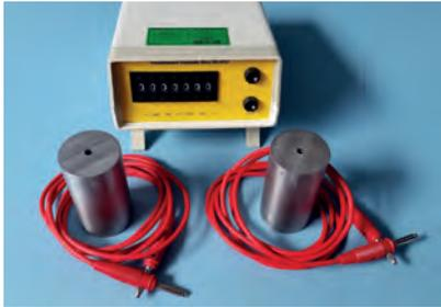
Contrôle d'étalonnage. Appareil permettant de contrôler l'étalonnage des testeurs d'entrée de zone EPA.
