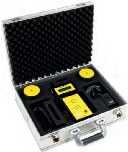
Téra-ohmmètre permettant de mesurer de  $10^4 \Omega$  à  $10^{12} \Omega$ . Mesure la résistance, la température et l'humidité simultanément.
