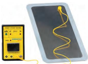
Testeur de bracelet portable ou mural, indiquant des résistances trop hautes ou trop basses. Fonctionne sur piles avec un témoin d'usure des piles.
