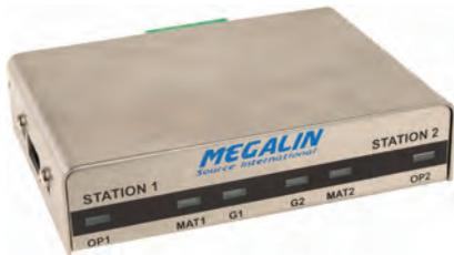
Contrôleur très compact (photo à l'échelle) permettant de contrôler la mise à la terre de 2 opérateurs et/ou 2 tapis de table ESD simultanément.
