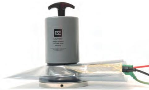
Permet la mesure de résistance de surface et de résistance de volume de matériaux plats selon la norme IEC 61340-2-3.
