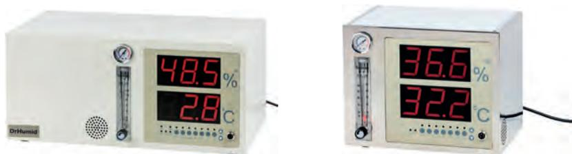
Les systèmes de contrôles d'humidité peuvent être placés dans les armoires ou tout autre système de stockage ou de déshumidification. Ils mesurent et enregistrent en temps réel les conditions de stockage de composants sensibles.
