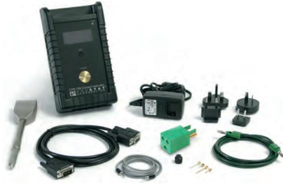
Le Voltmètre Contact CVM-780 combine la facilité d'utilisation d'un voltmètre numérique, avec l'impédance élevée et la faible capacitance d'un véritable voltmètre électrostatique dans un petit pack portable. Il lit la tension réelle, sans interférence avec l'intensité du champ électrostatique. Les embouts en céramique de la sonde permettent une mesure précise des valeurs.
