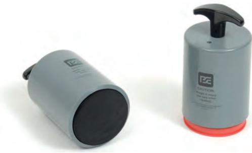
Permet de faire les mesures point à point et les résistances à la terre selon la norme IEC 61340-4-1 et IEC61340-2-3.
